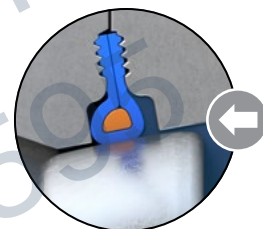
Disque en Position Fermée. Pression dans le sens d'écoulement non-préférentiel .
