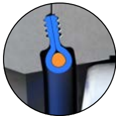
Disco en Posición Abierta. Asiento no comprimido.
