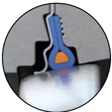
Sem pressão da linha. (Condição de evento de pré-incêndio.)
