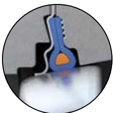
Kein Leitungsdruck. (Bedingung vor dem Brand.)
