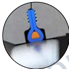
Geschlossene Stellung. Kein Leitungsdruck.
