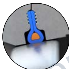
阀板处于关闭位置。 无管线压力。
