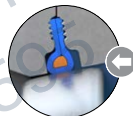
阀板处于关闭位置。 从非首选流向施加的管线压力。
