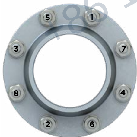
Figure 2 – Schéma de Serrage de Boulons de Bride
