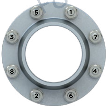
Abbildung 2 – Anzugsmuster der Flanschschrauben
