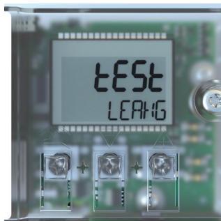
zahájení zkoušky těsnosti
